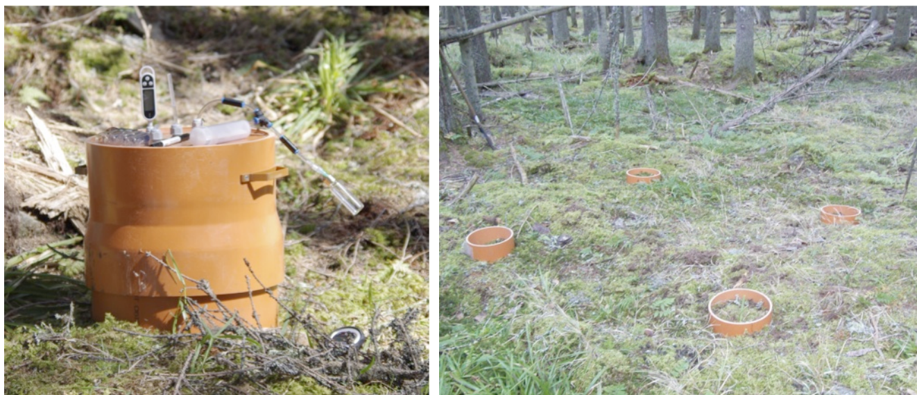
Figura 10. Stânga, camera de respirație închisă pentru prelevare de gaze. Dreapta, localizarea celor patru inele folosite pentru fiecare suprafață de monitorizare, aici în pădurea naturală Giumalău.
