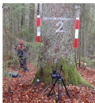
Figure 7. Pozitionarea echipamentului pentru colectarea de fotografii emisferice
