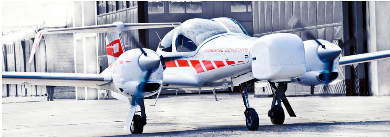
Figura 1. Avion Diamond DA 42 MPP echipat cu aparatura fotogrametrica instalata frontal
